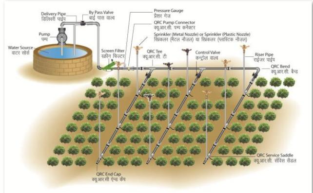
Layout of Sprinkler Irrigation System (छिपकाव सिंचाई प्रणाली का रेखाचित्र)
